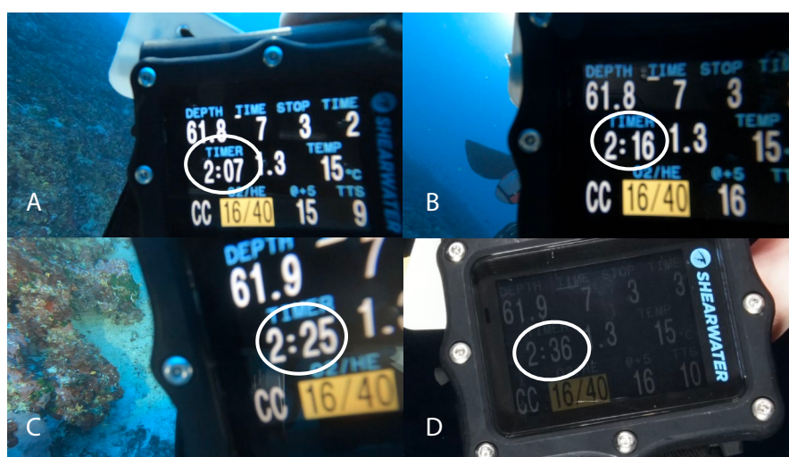
Figure 4 : Capture d'écrans de l'ordinateur de plongée Shearwater Perdrix utilisé avec chronomètre afin de synchroniser les prises de vues (A=GP1, B=GP2, C=GP3, D=A7II).
