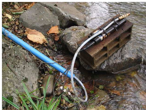
Localisation du matériel de mesure de la turbidité et de prélèvement des eaux
