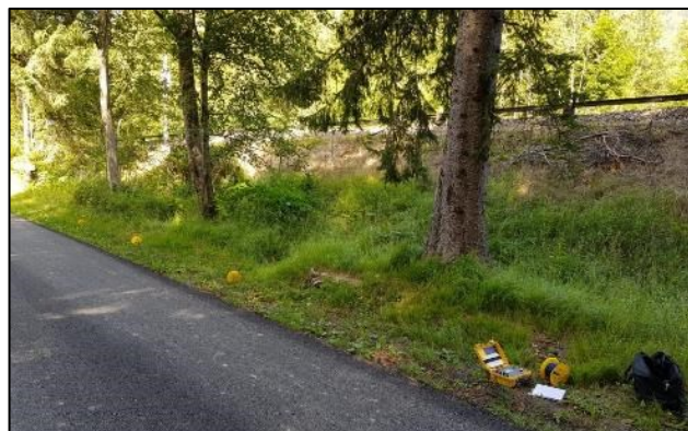
Figure 2 - Vue de la mesure de résistivité par la méthode des 4 piquets (WENNER)
