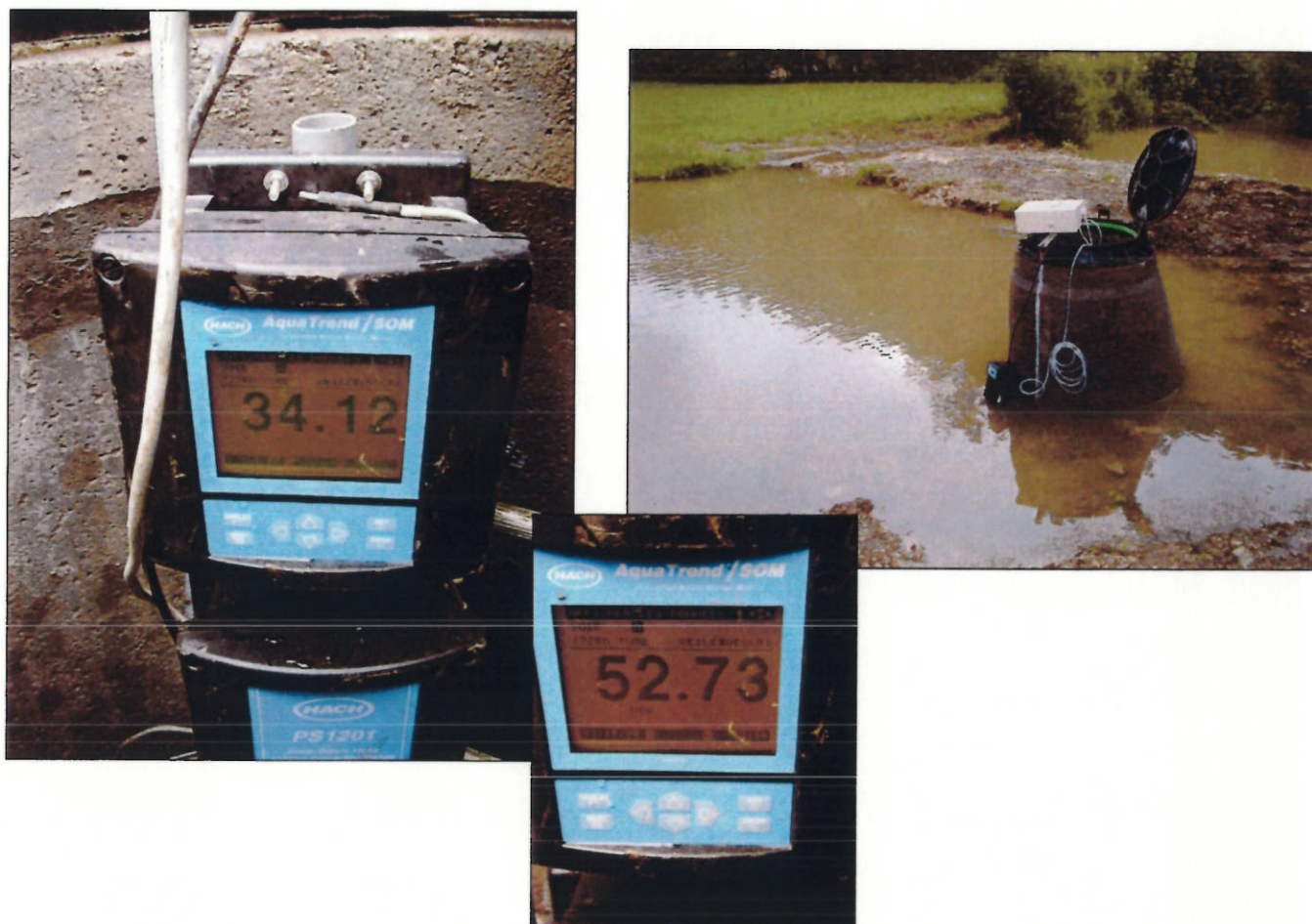
Photos 9 : Turbidimètre Hach en continu sur site Détail des mesures maximales de turbidité le 14 juillet 1999 34,12 NTU sur la source de Froidefontaine 52,73 NTU sur le cours du Dessoubre
