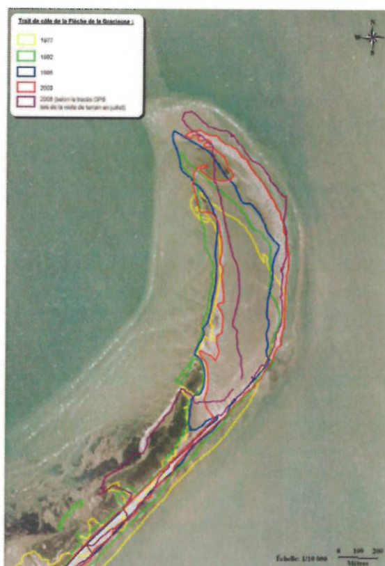
Figure 3-13 : Évolution du trait de côte de la flèche de la Gracieuse entre 1977 et 2008 (traits de côte entre 1977 et 2003 à partir des photographies aériennes et en 2008 à partir des relevés GPS en limite terre-mer lors de la visite de terrain effectuée le 31 juillet 2008 (Sources : IGN, 1977, 1992, 1998 et 2003, SAFEGE, 2008)
