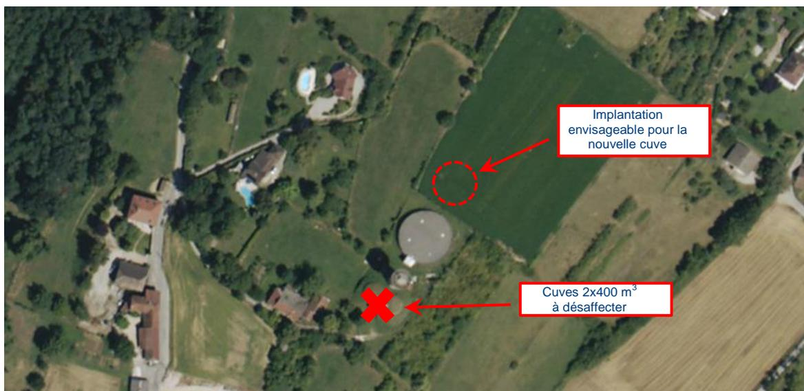
Les cuves de 400 m<sup>3</sup> pourront être désaffectées ou même détruites s'il apparaît que cela ne sera pas préjudiciable à la stabilité du réservoir sur tour du Haut Service et si ce dernier est maintenu en service.
