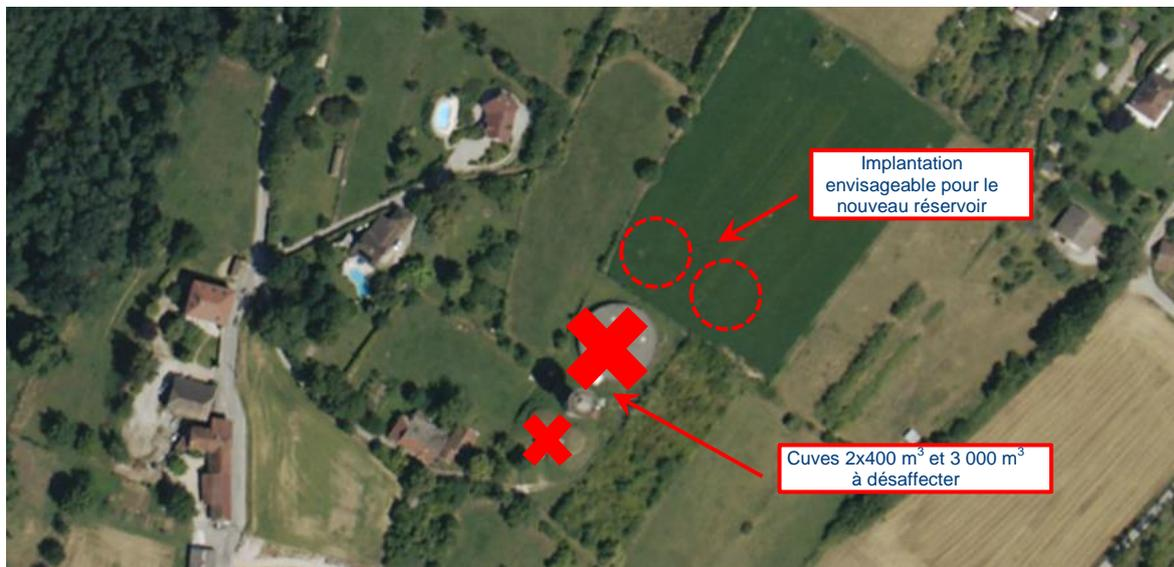
La cuve de 3 000 m<sup>3</sup> pourra être désaffectée ou même détruite ainsi que les cuves de 400 m<sup>3</sup> s'il apparaît que cela ne sera pas préjudiciable à la stabilité du réservoir sur tour du Haut Service et si ce dernier est maintenu en service.
