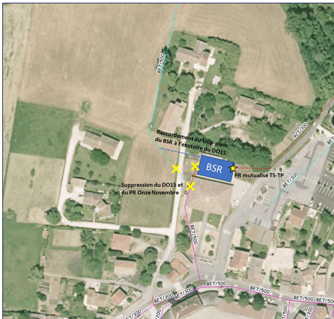
Figure 45 : Schéma de principe de la création d'un BSR au droit du PR Onze Novembre
