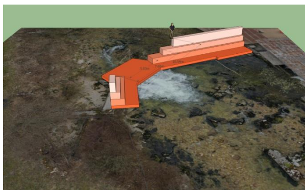
Figure 21 : Maquette 3D du seuil Paget, avant et après arasement
