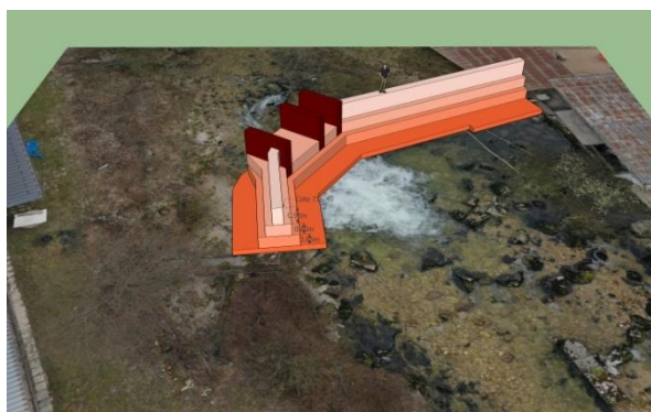
Figure 21 : Maquette 3D du seuil Paget, avant et après arasement
