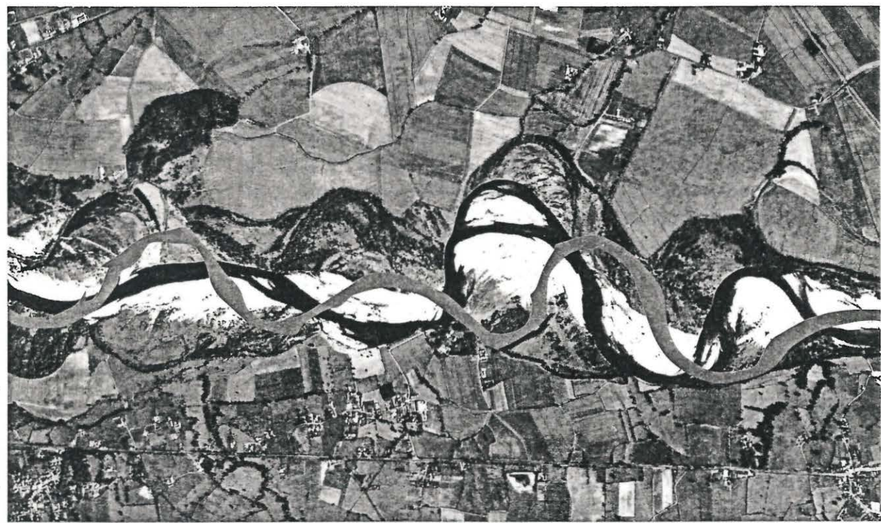
Vue en plan d'un cours d'eau à dynamique active. Tracé actuel (photo) Tracé de 1946 (trame bleue)
