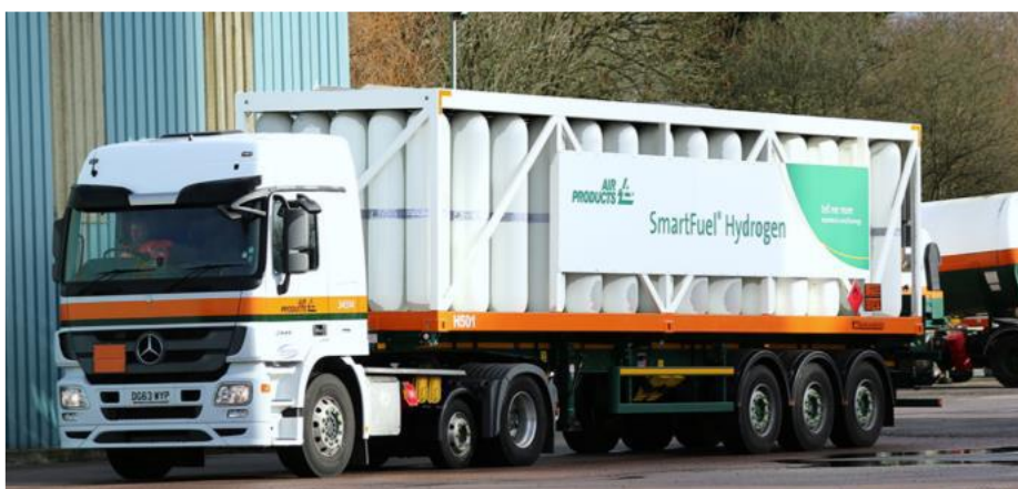
Figure 15 : Exemple de remorque équipée des réservoirs contenus dans un conteneur (source : QAir (2022), Dossier de demande d'Autorisation Environnementale – Etude d'Impact sur l'Environnement et la Santé. Projet HYD'OCC et son raccordement au réseau public de transport)
