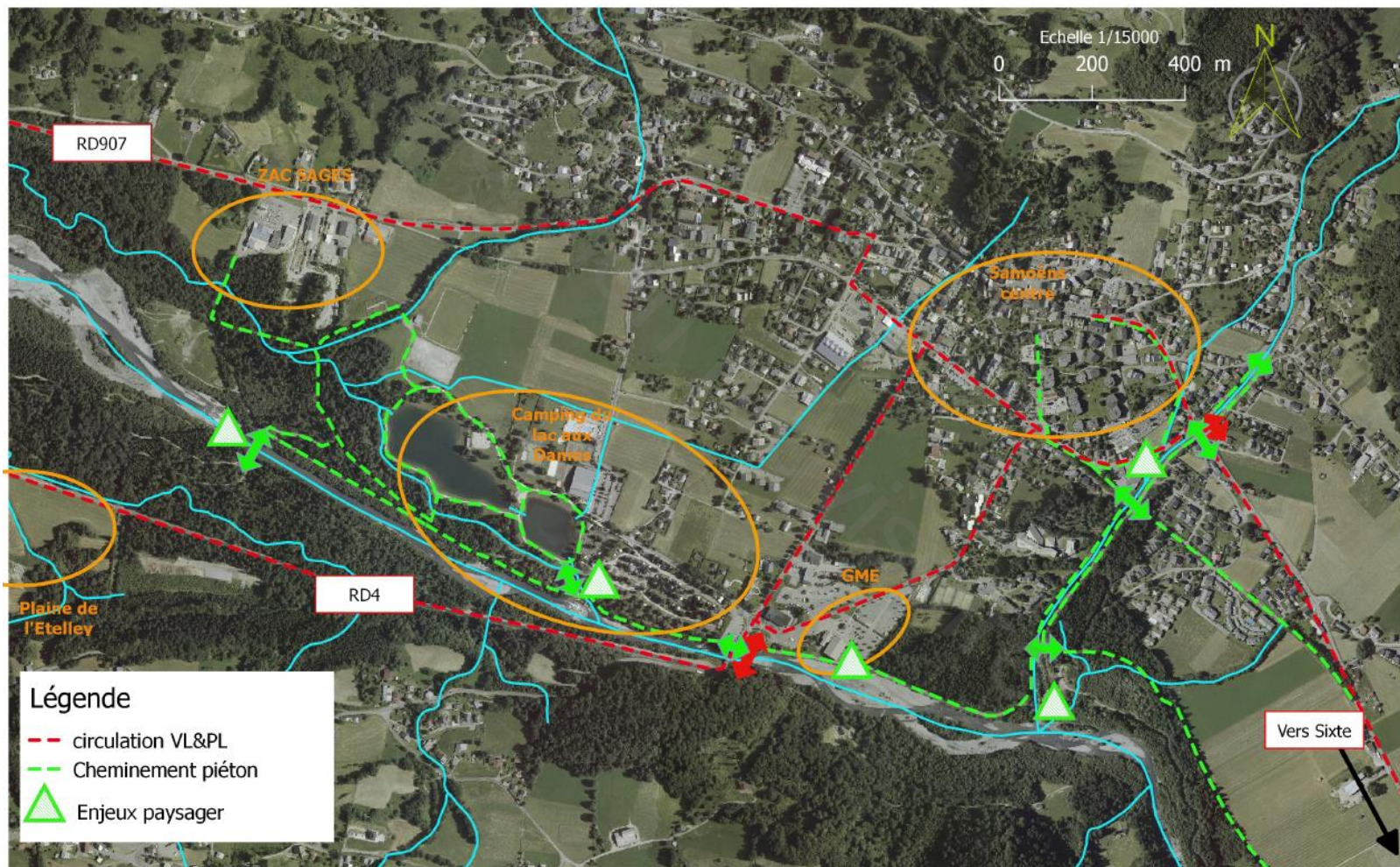
Figure 2: Cartographie des grands axes et des enjeux de circulation VL & PL et piéton dans la zone d'étude.
