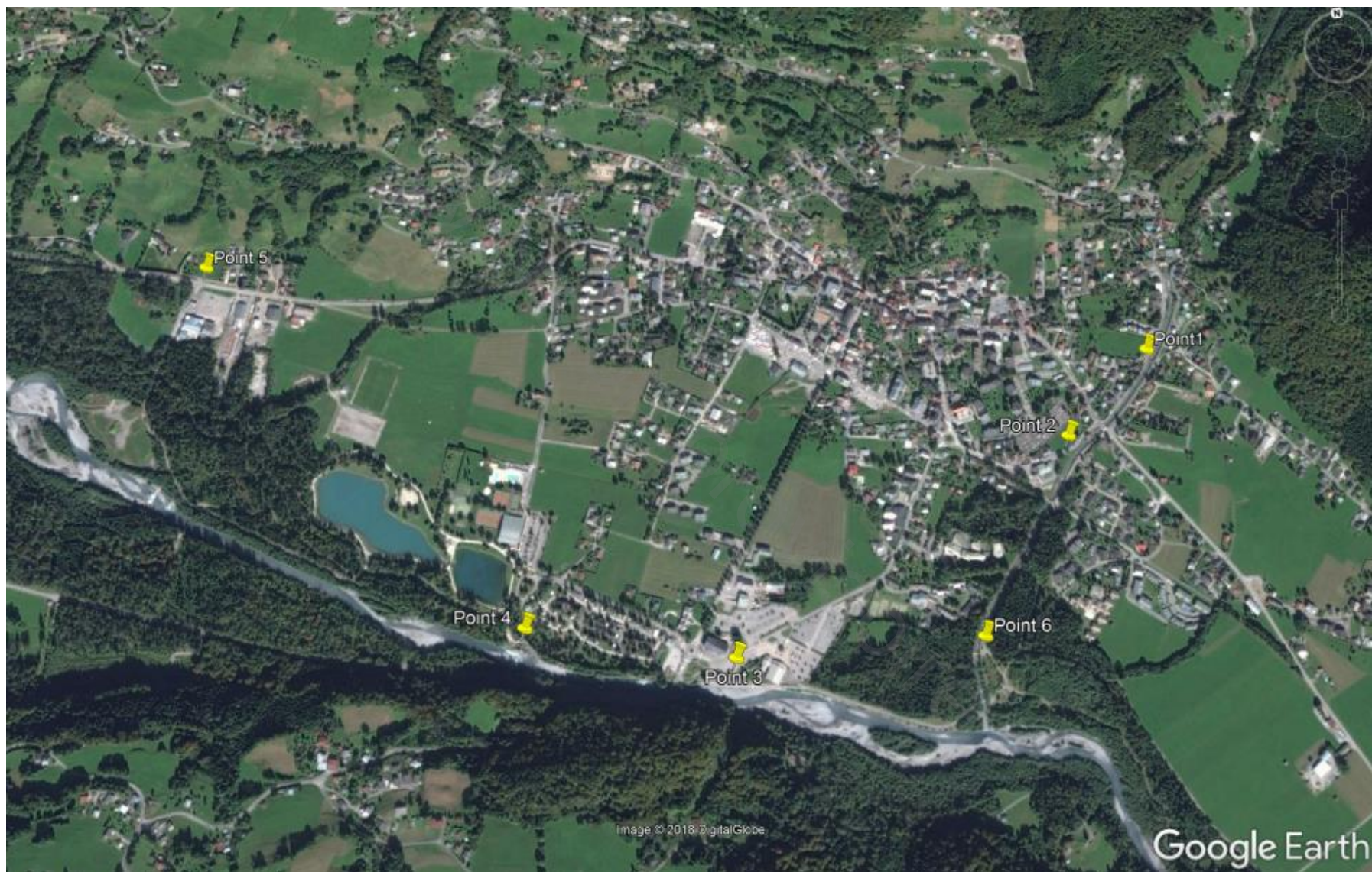
Figure 98: Implantation de la polygonale principale à réaliser en phase PROjet (source Google Earth)
