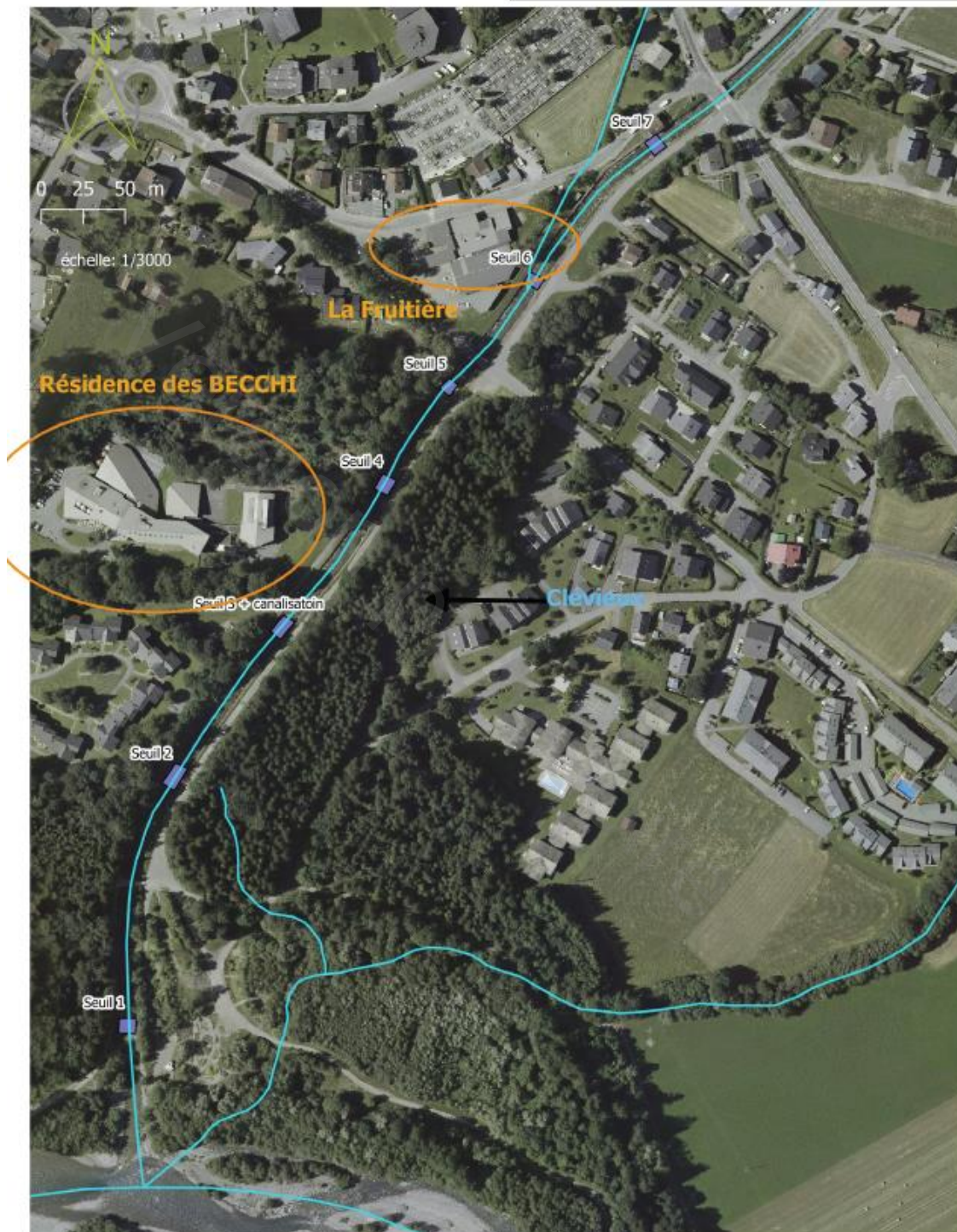
Figure 60: Localisation des seuils sur la partie aval du Clévieux - 7 seuils
