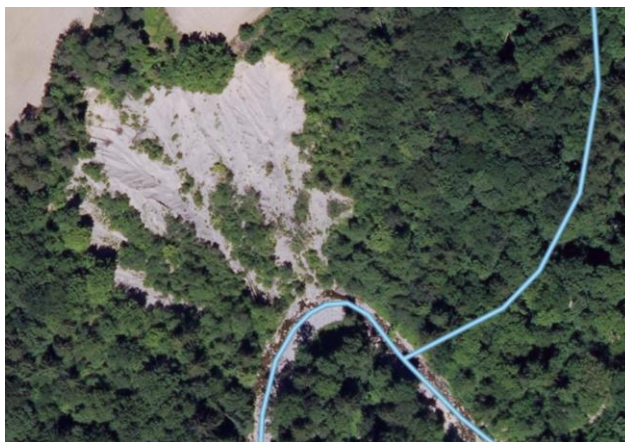
Figure 9 : érosion de versant notable le long du Daudens (superficie d'environ 5000 m 2 )
