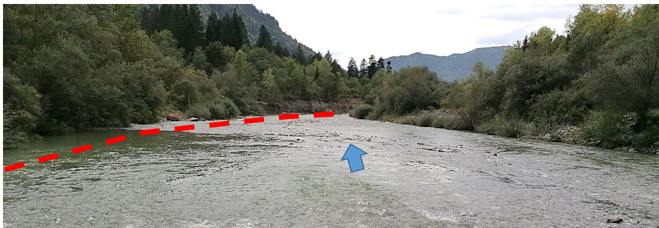
Fier à l'aval immédiat du contre-seuil du seuil naturel : cordon de réinjection à déposer tout le long du pied de berge gauche (cf. accès depuis pied du contre-seuil)
