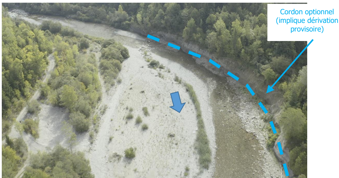
Vue été 2020 de l'aval du contre seuil du seuil naturel et de la berge gauche active en érosion
