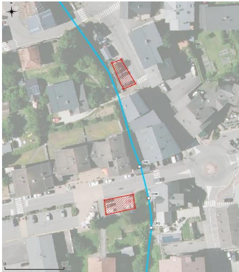
Figure 28 : Proposition de localisation des installations de chantier pour le secteur amont (hachures rouge sur la carte) (source : BURGEAP)
