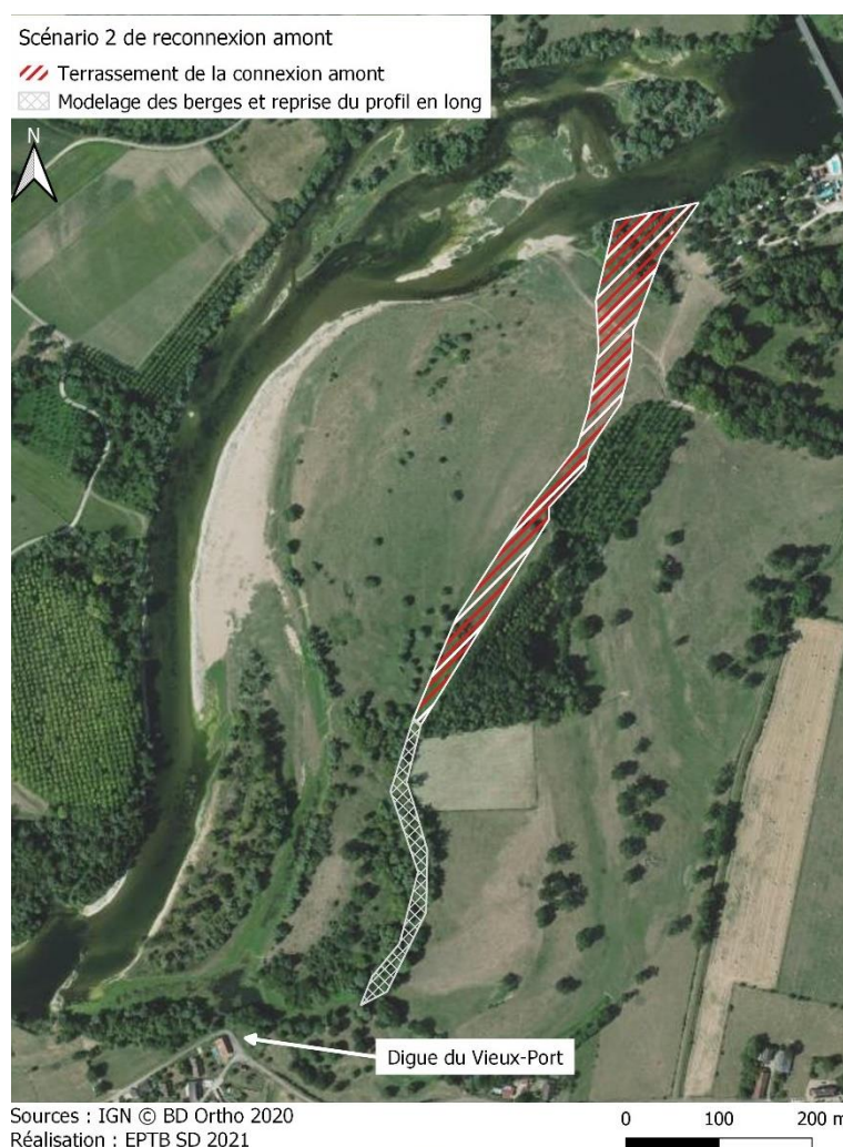
Figure 29 – Cartographie des aménagements pour une reconnexion amont du bras n°2
