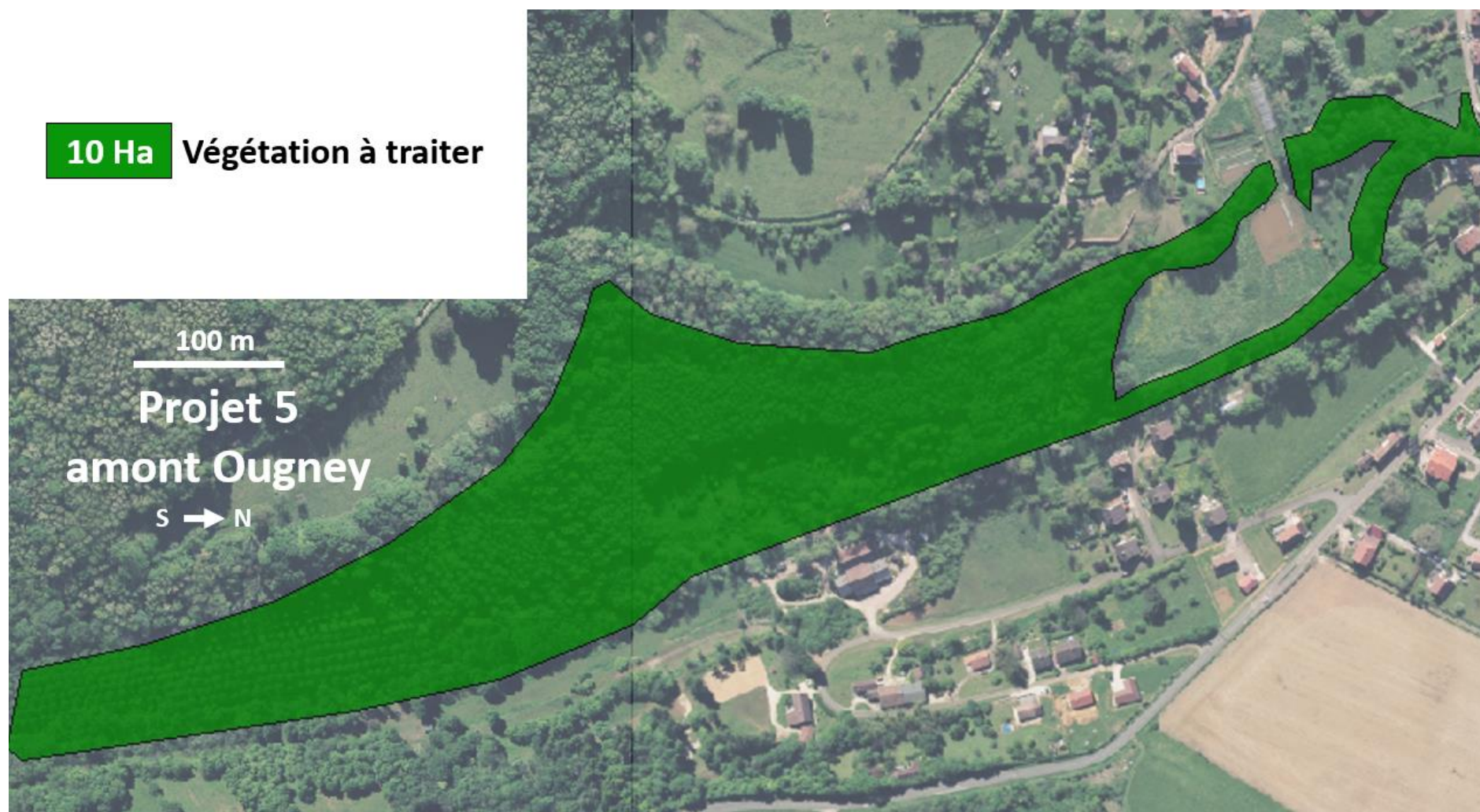
Figure 9.12 : Végétation ligneuse à déboiser pour le besoin des travaux du projet « 5 Amont Ougney ».
