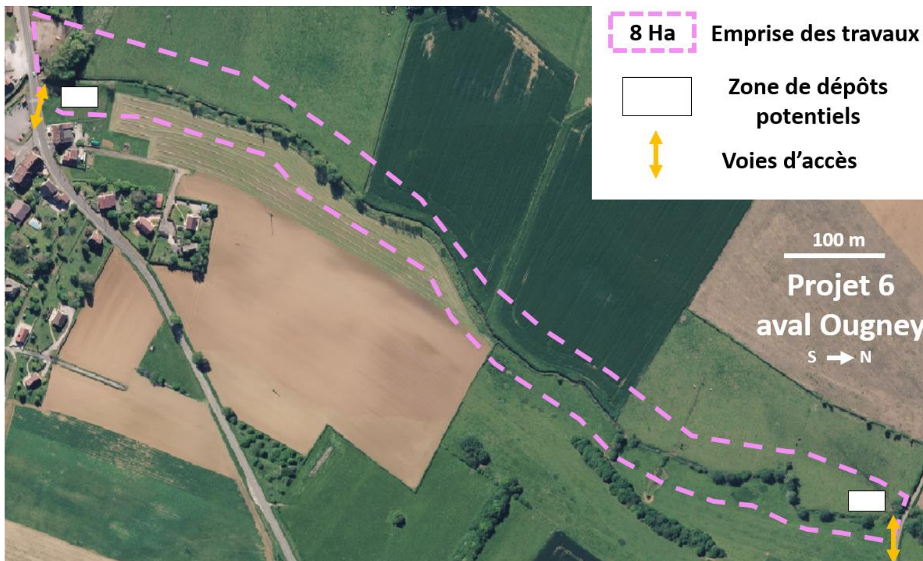
Figure 9.6 : Voies d'accès au chantier (flèches blanches) et zone de dépôts pressenties (carrés blancs) pour le projet « 6 Aval Ougney ».
