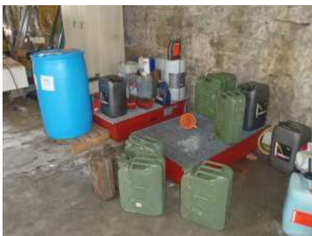
Atelier avec stockage de la plupart des bidons sur cuve de rétention
