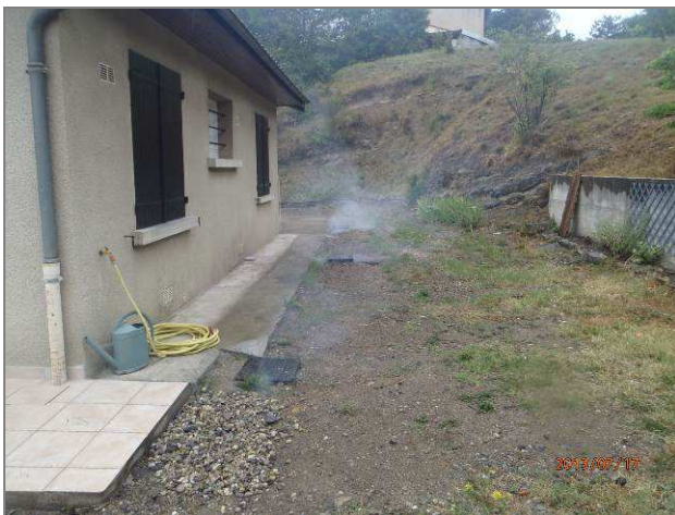
Illustration n°7: Photos d'anomalies à la fumée : Boîte non étanche (G) et gouttière raccordée (D)
