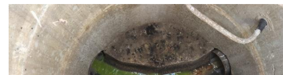
3 - Validation de la connexion hydraulique à l'aide de colorant
