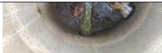
3 - Validation de la connexion hydraulique à l'aide de colorant
