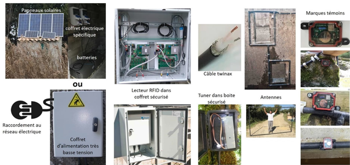
Figure 9 : Illustrations des différents éléments constituant une station fixe de suivi RFID.
