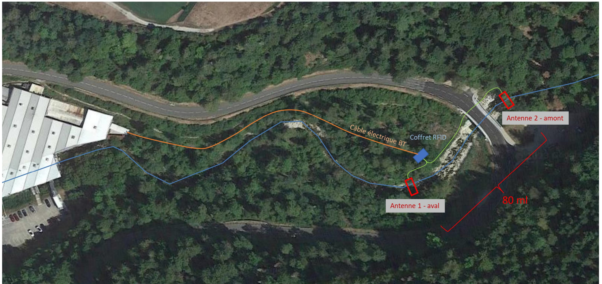
Figure 11 : Schéma d'implantation du système RFID installé sur le Grosdar.
