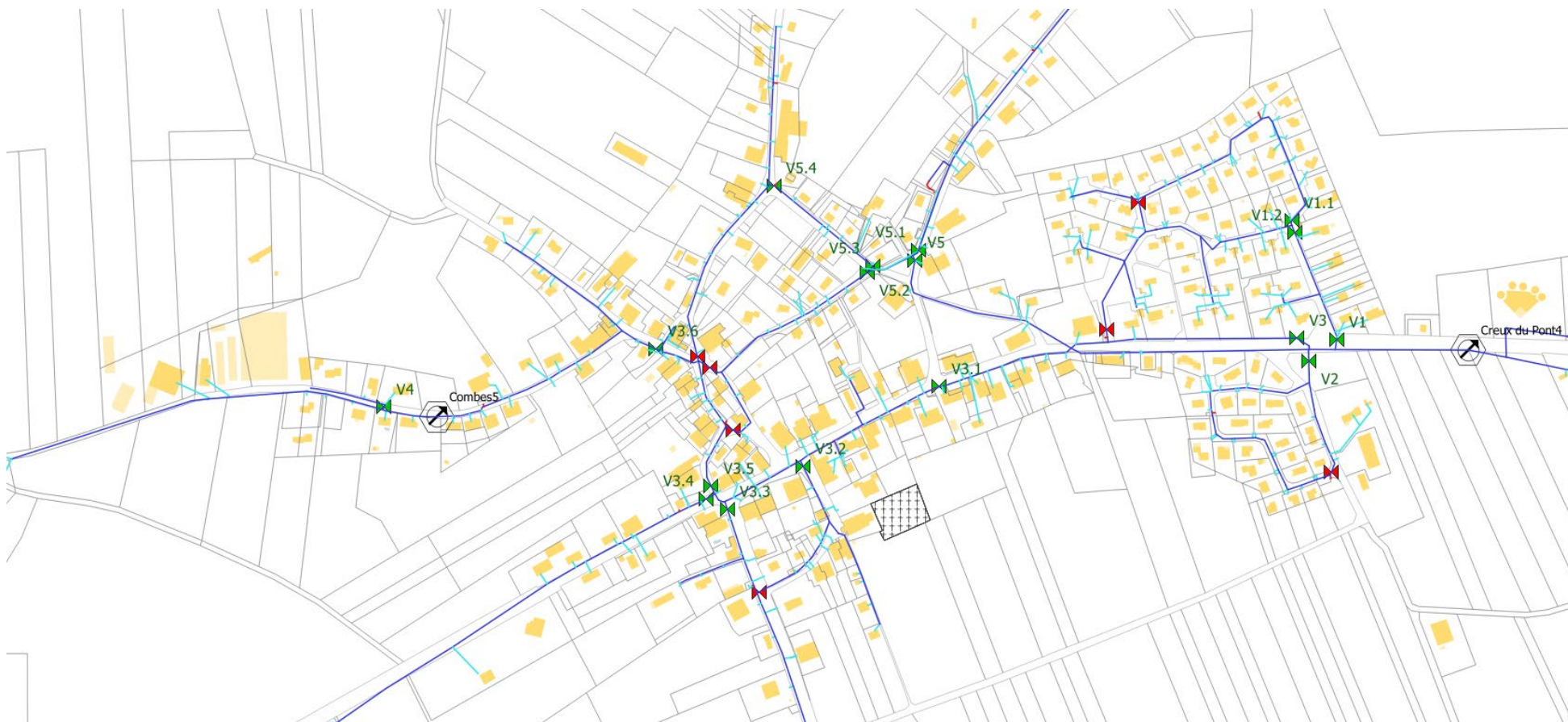
Figure 46 : Numérotation des vannes manœuvrées pendant la nuit de sectorisation
