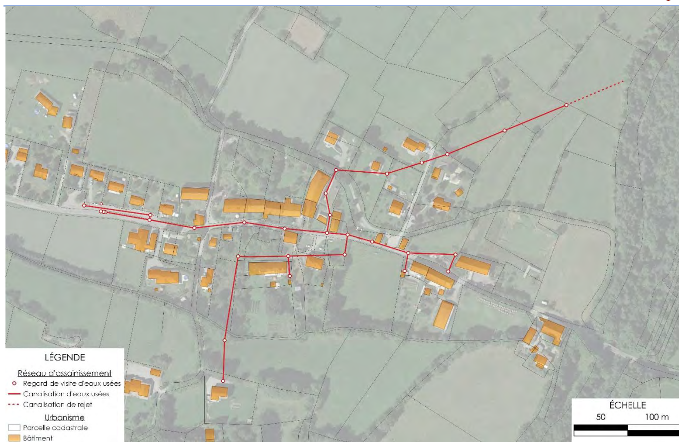
Figure 15 - Plans du réseau d'eaux usées des Forestons
