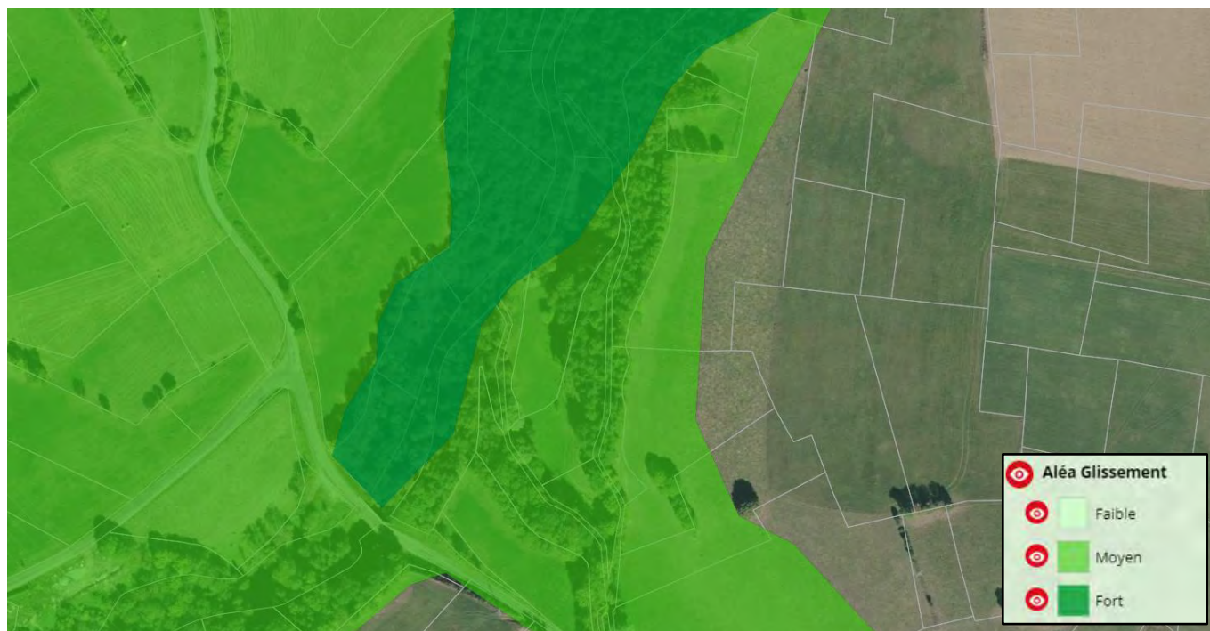
Figure 47 - Cartographie de l'aléa glissement de terrain à proximité des parcelles envisagées pour la STEU du Chef-Lieu
