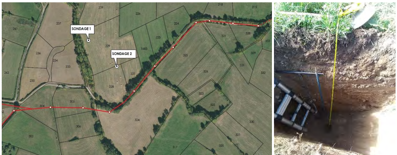
Figure 42 - Localisation des sondages réalisés et photographie de l'étude de capacité d'infiltration du sol (Chef-Lieu)
