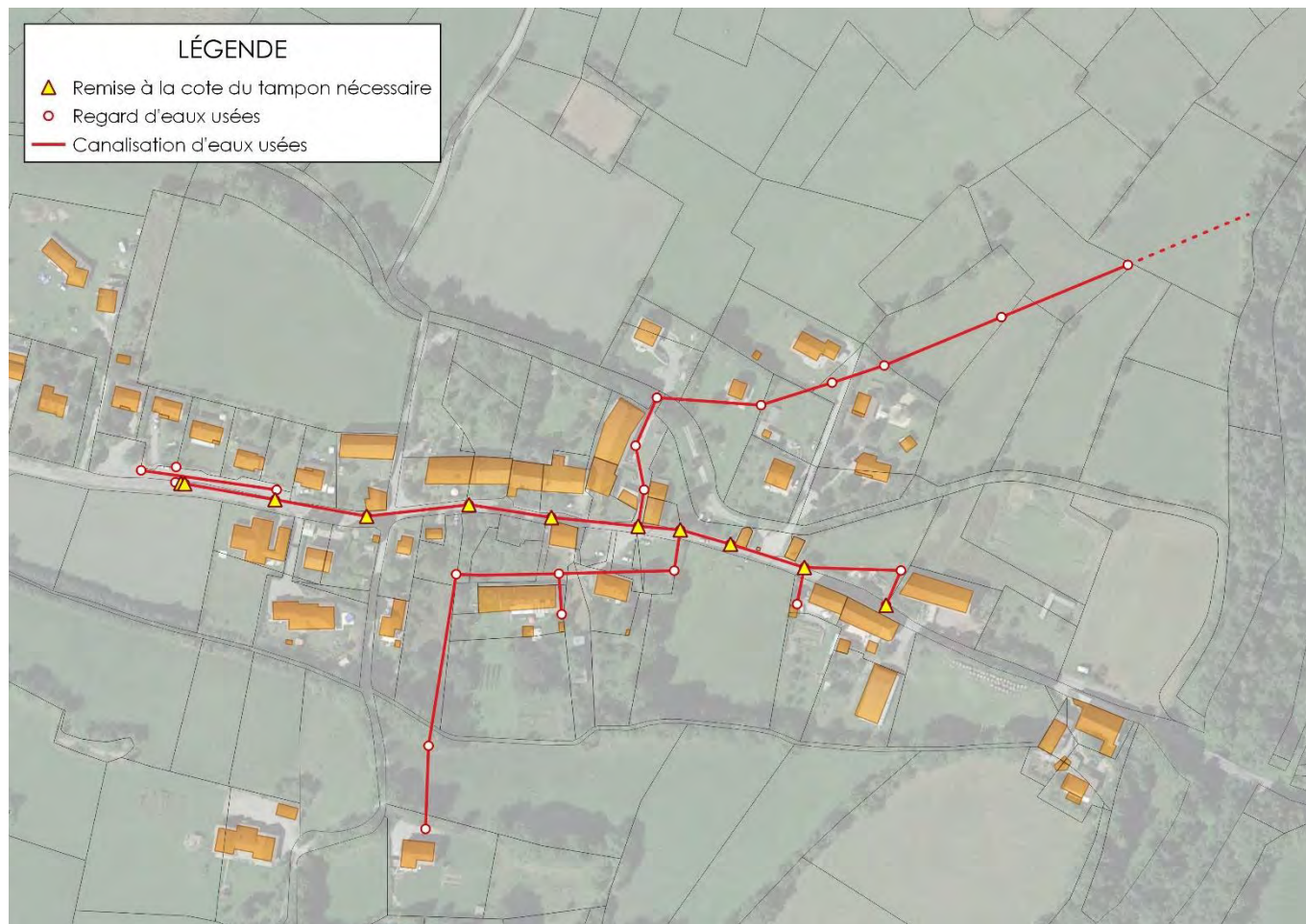
Figure 93 - Localisation des tampons de regards de visite à remettre à la cote aux Forestons
