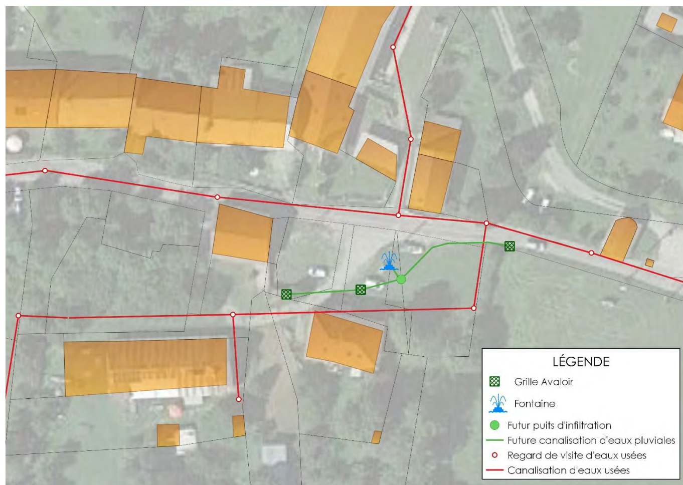
Figure 95 – Illustration de la déconnexion des 3 grilles avaloir et de la fontaine des Forestons
