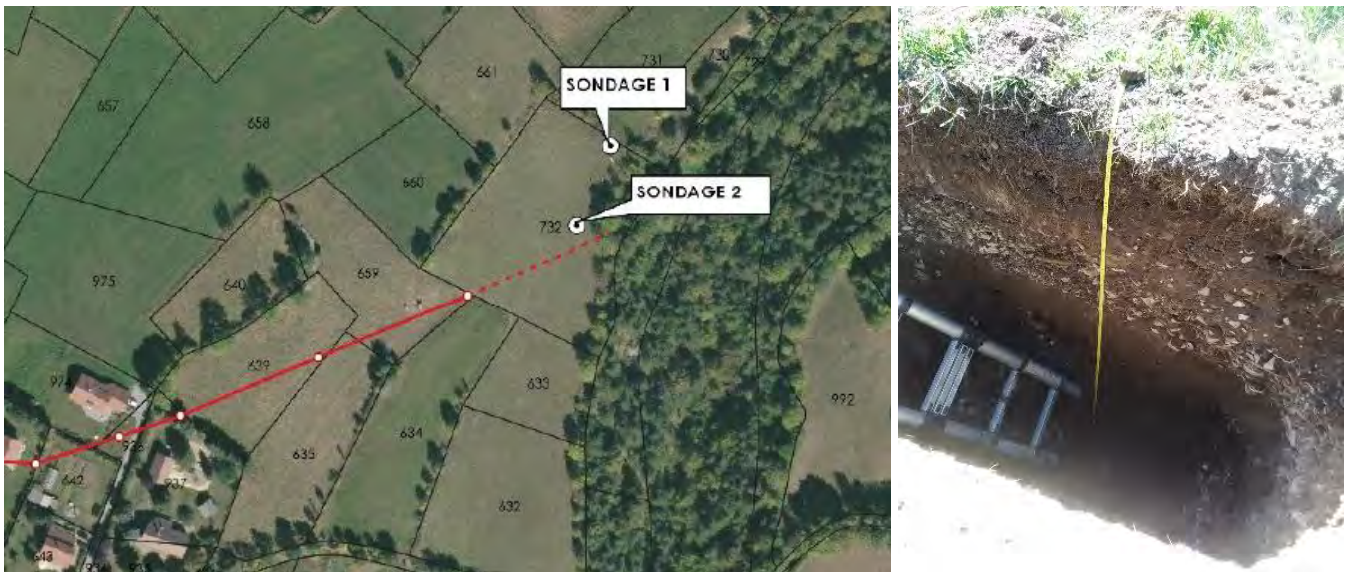
Figure 87 - Localisation des sondages réalisés et photographie de l'étude de capacité d'infiltration du sol (Forestons)
