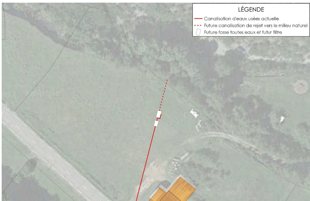
Figure 105 - Schéma d'implantation de principe de la future STEU des Basses-Barraques (zoom)
