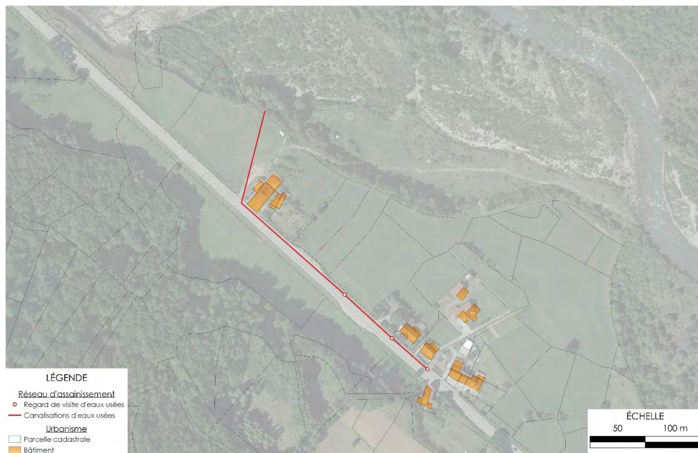
Figure 16 - Plans du réseau d'eaux usées des Basses-Barraques
