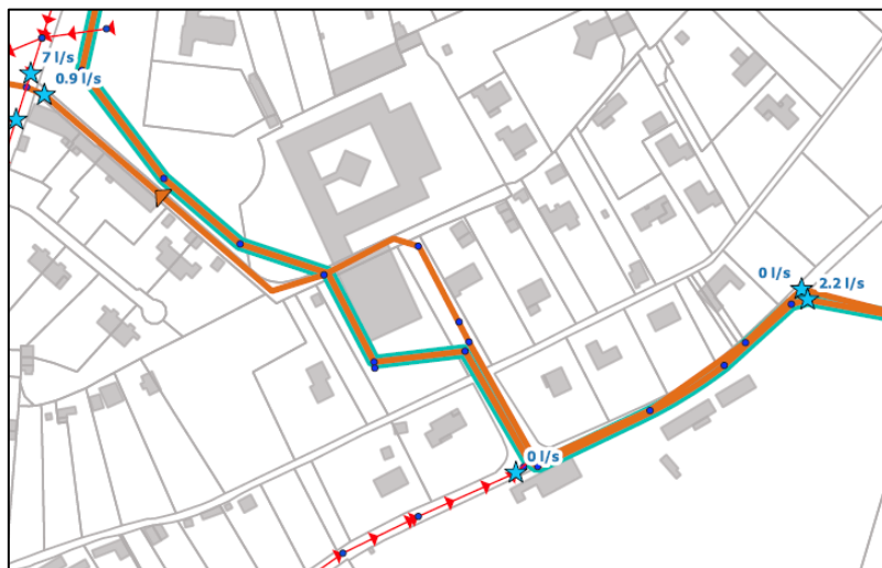
Figure 14 : Cartographie des intrusions observées sur la partie Est de l'ancien réseau du SITTEU
