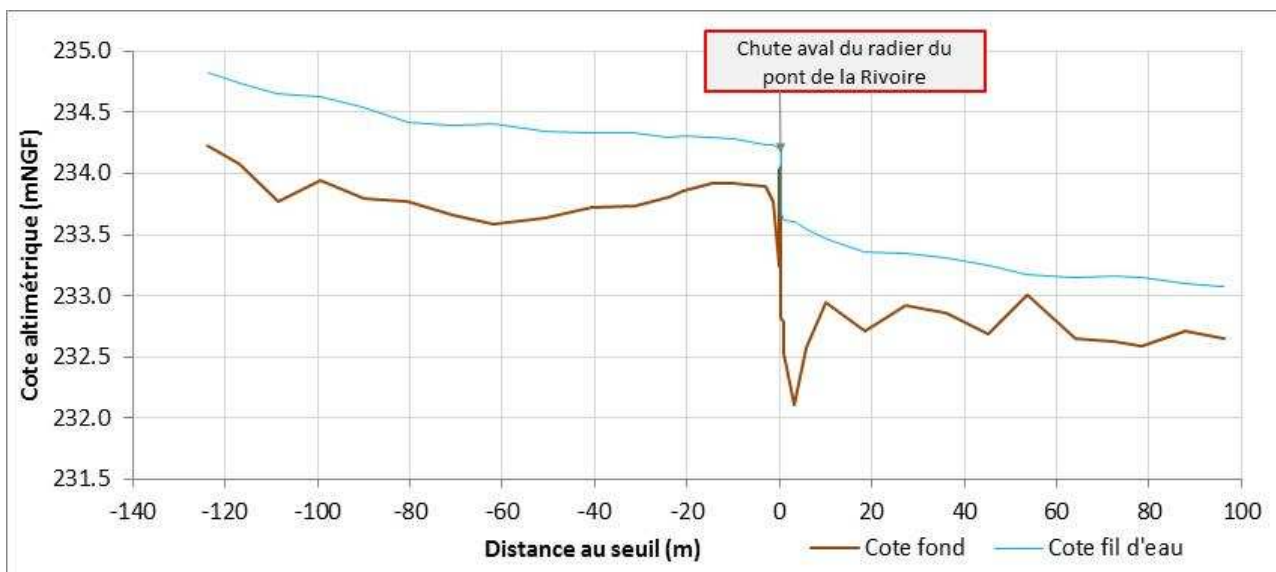
Figure 11 : Profil en long de la Bourbre au droit du pont de la Rivoire
