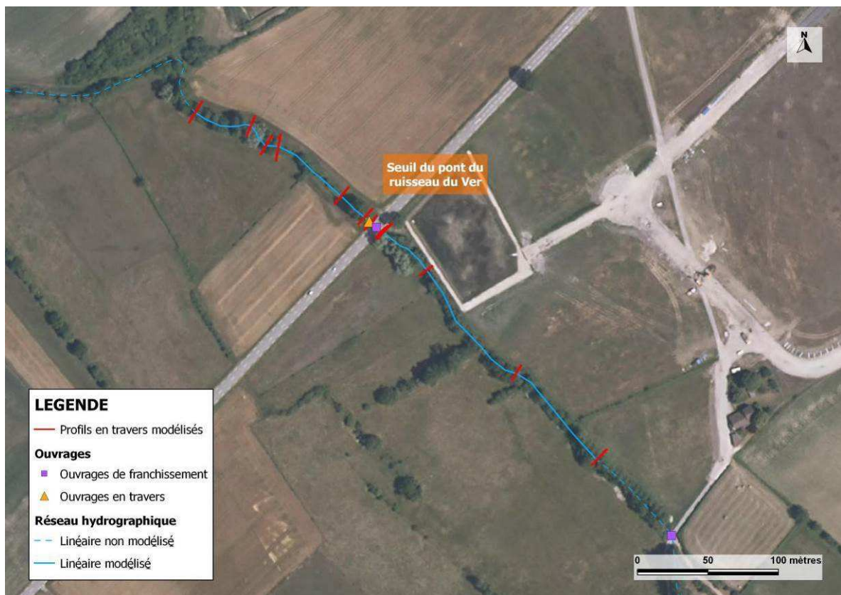
FIGURE 13 : PROFILS EN TRAVERS DU MODÈLE HYDRAULIQUE DU PONT DU RUISSEAU DU VER
