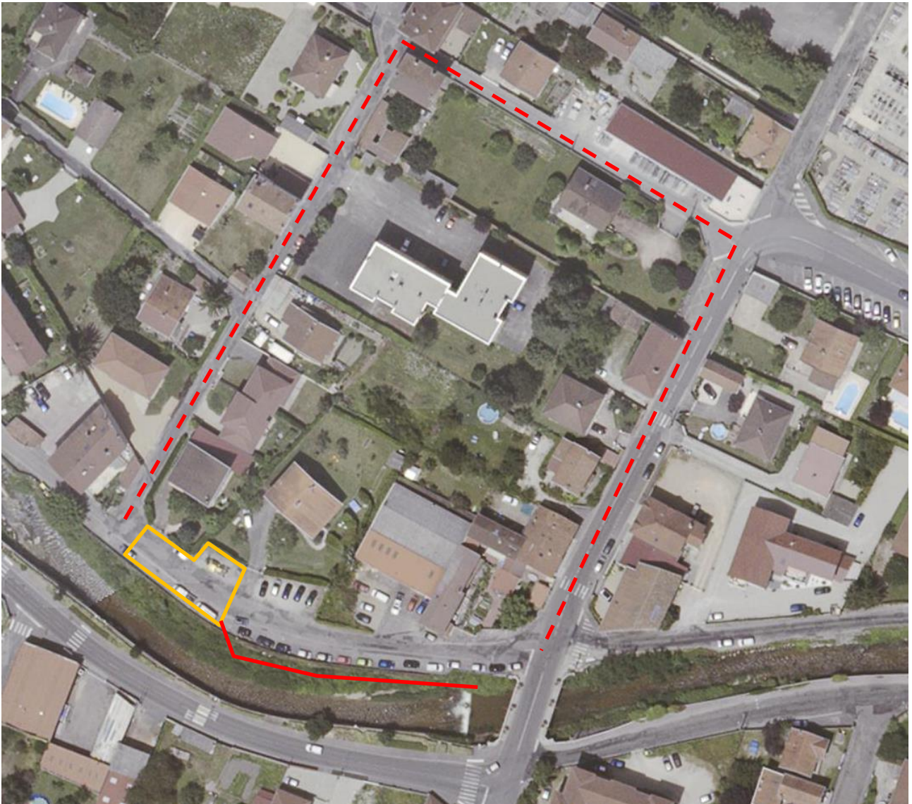
Figure 3 : Accès de chantier et déviation
