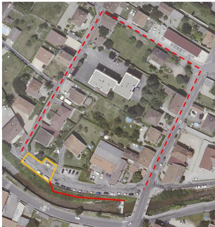
Figure 2 : Accès de chantier et déviation
