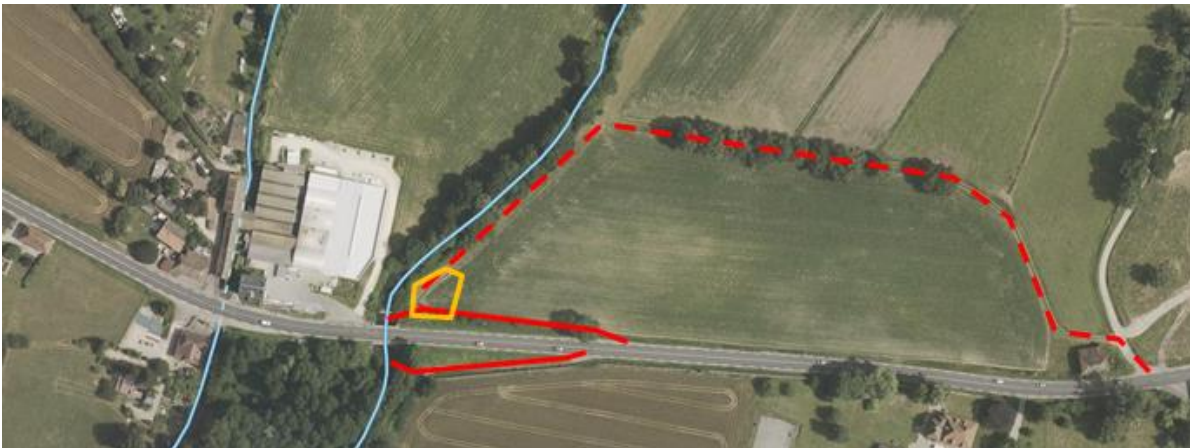
Figure 3 : Accès de chantier et stockage temporaire
