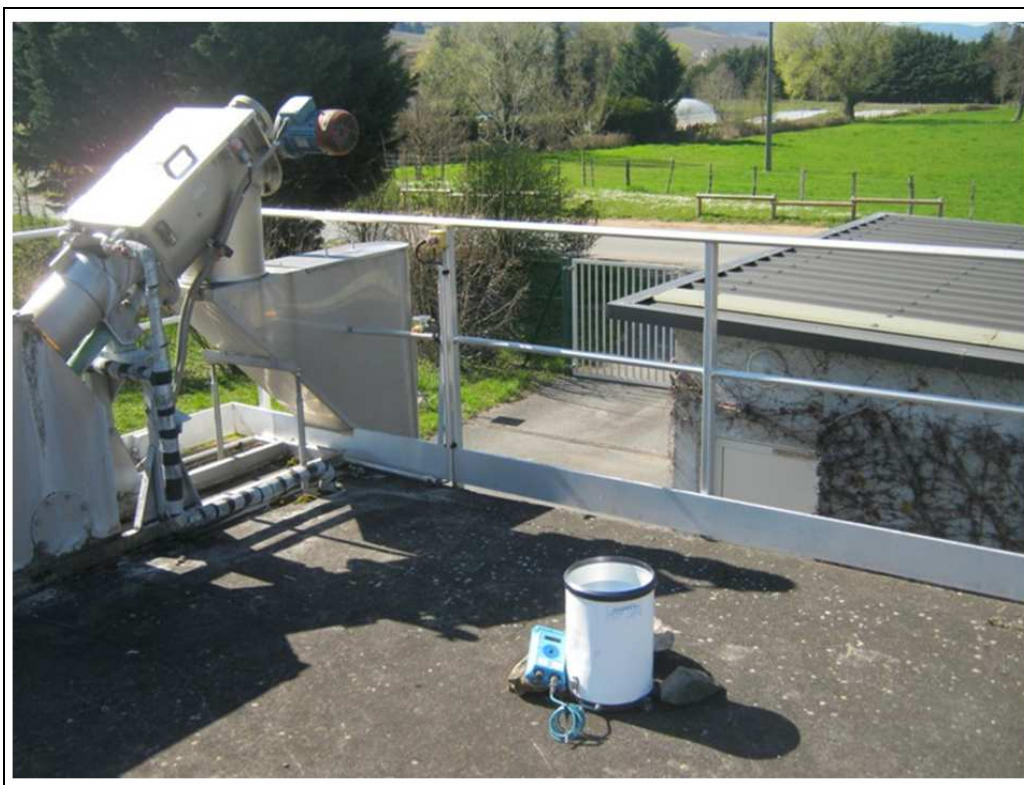
Figure 14 : Présentation du pluviomètre
