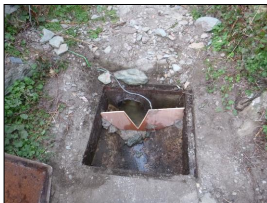
Photo 6 : LAINOSA - Matériel de mesure posé au niveau du regard n°41
