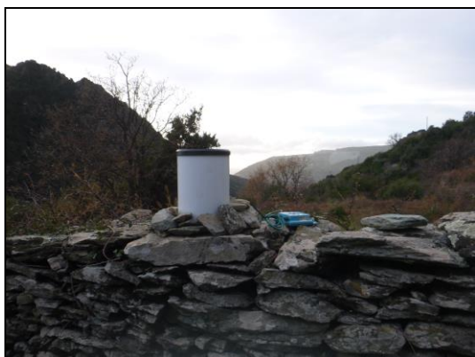
Photo 5 : Pluviomètre à auget mis en place à proximité du regard n°40
