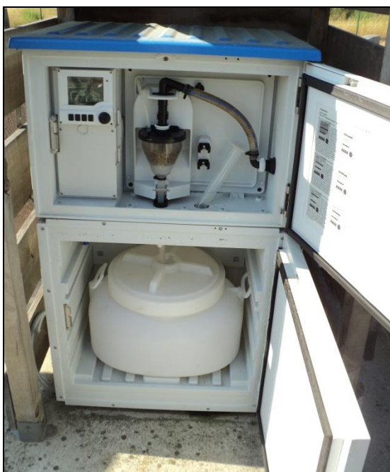
Figure 29 : vue des préleveurs automatiques en entrée et sortie de traitement
