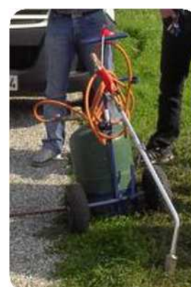
Exemple d'outils portés à lance de désherbage thermique
