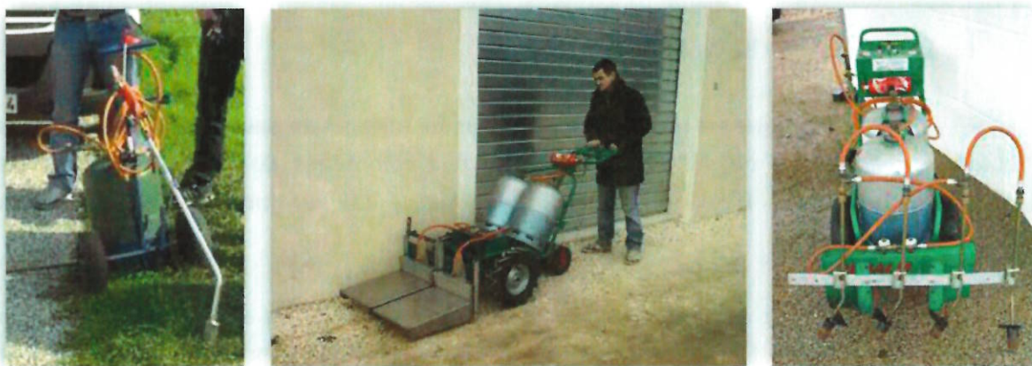
Désherbeurs thermiques à flamme directe (lance simple), à infrarouge et désherbeur thermique à flamme directe (rampe 4 brûleurs)
