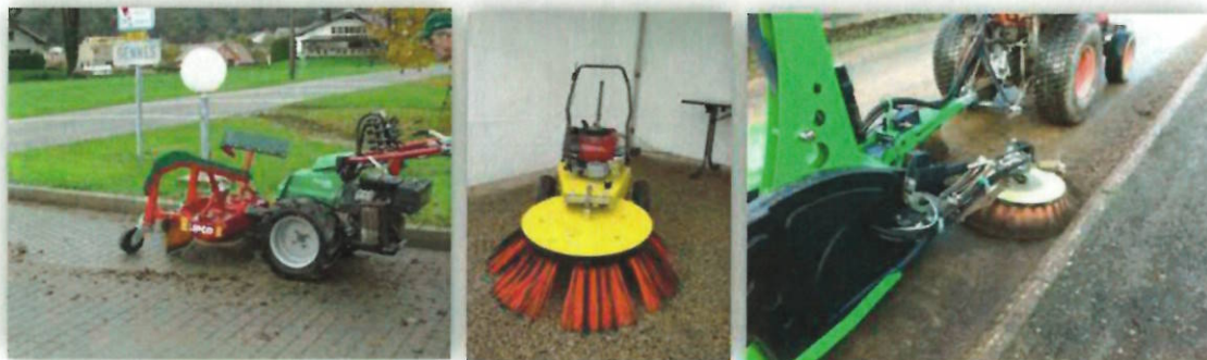
Exemple d'outils de balayage mécanique autoporté (Lipco) ou tracté (cochetsa.com)
