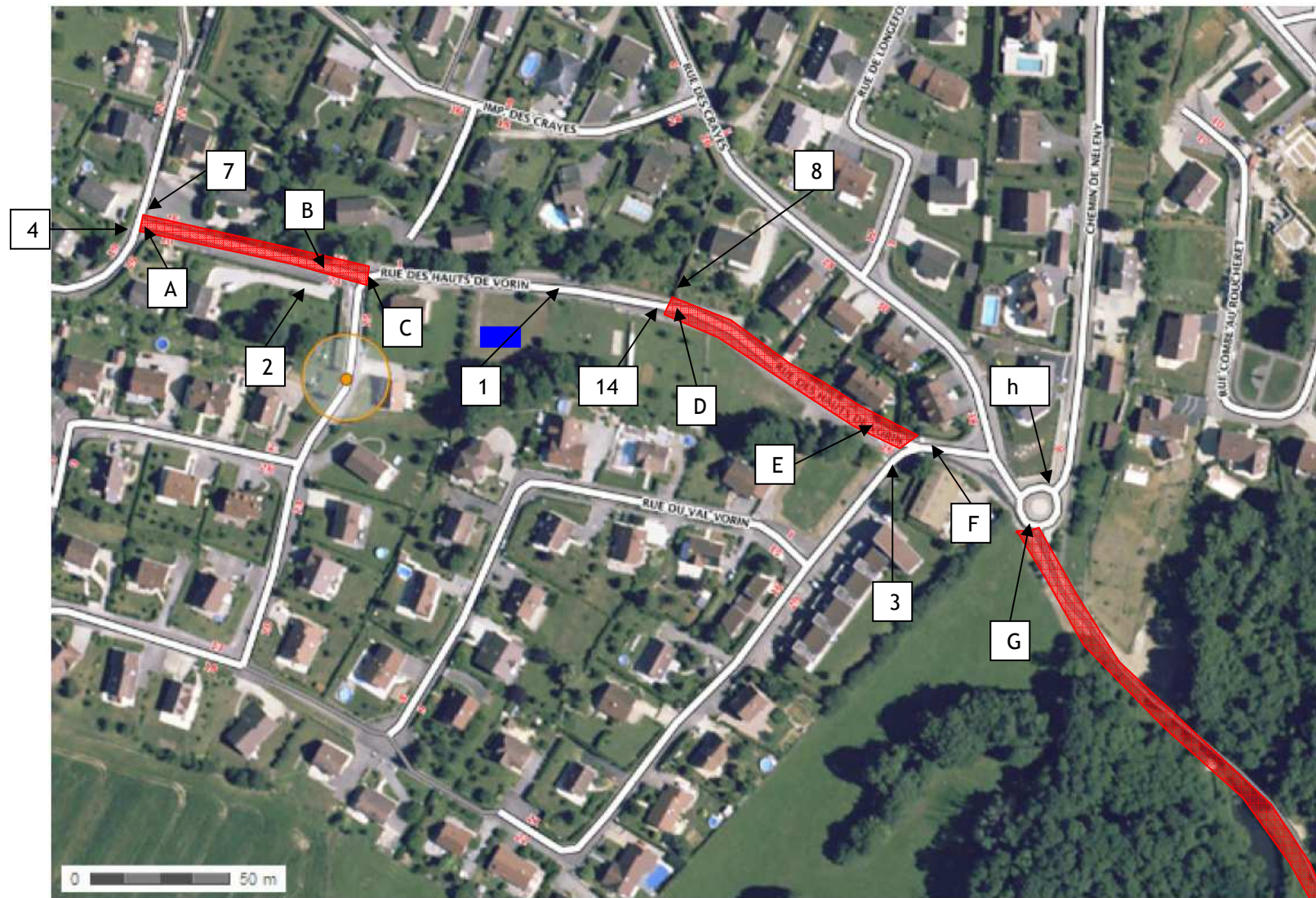
Figure n° 15 : Localisation des zones d'insuffisance sur le bassin versant des Hauts de Vorin pour une pluie de fréquence décennale
