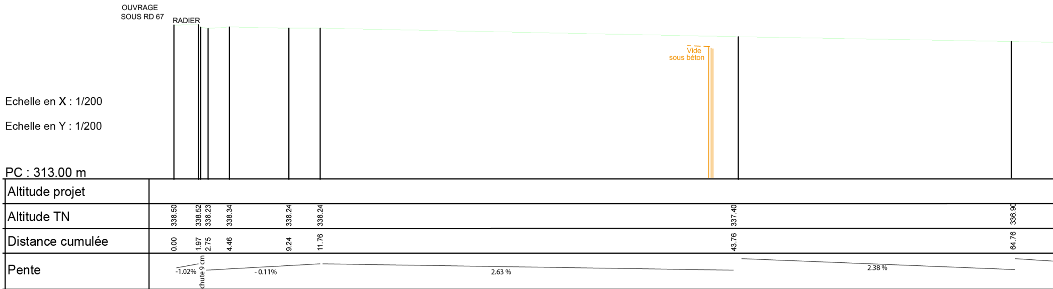
Coupe 17 : Coupe en long du projet de renaturation du ruisseau d'Amathay
