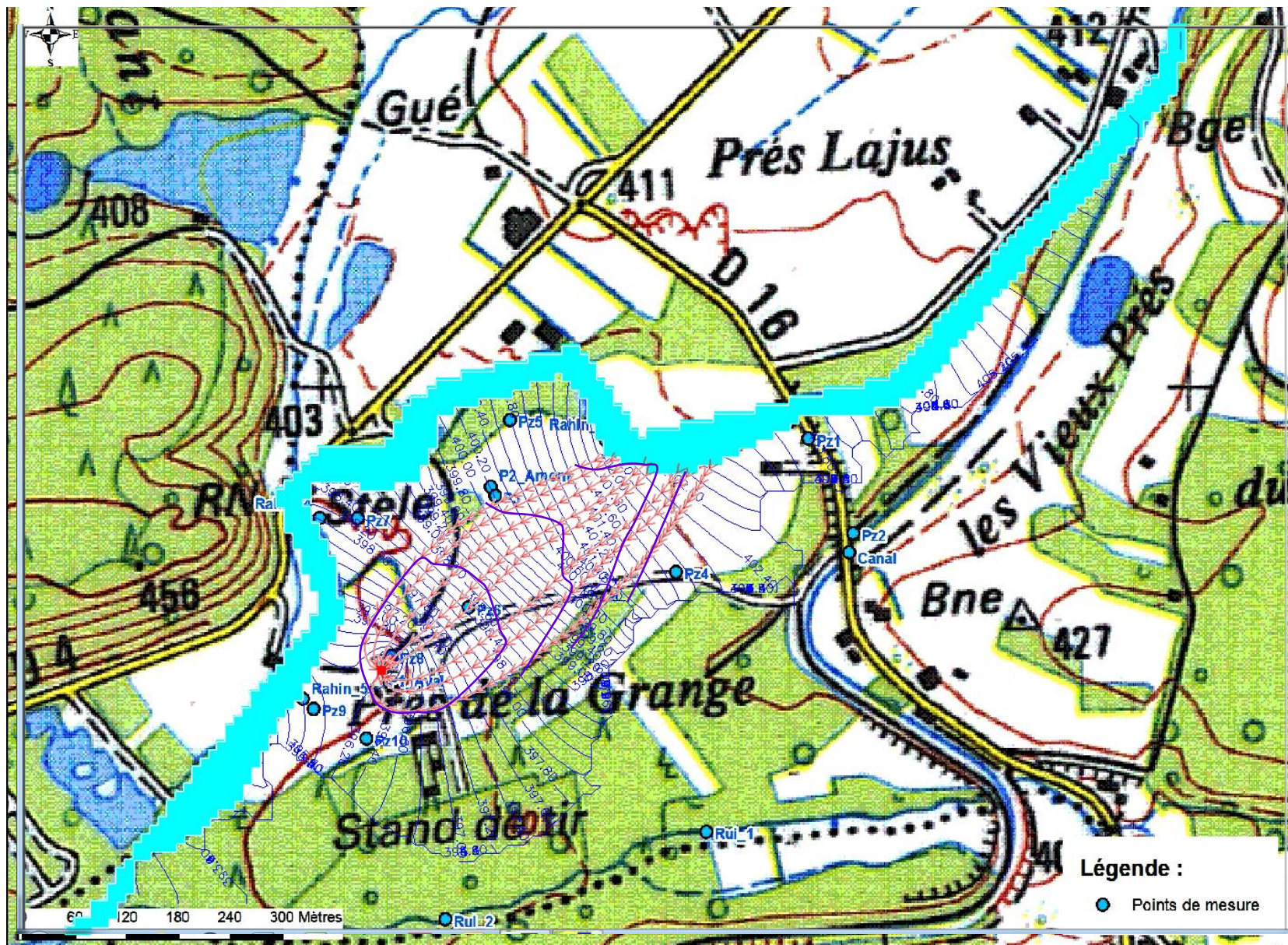
Figure 22 : Zone d'alimentation du puits P1 en pompage.
