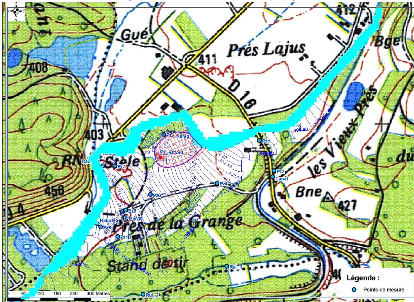
Figure 23 : Zone d'alimentation du puits P2 en pompage.
