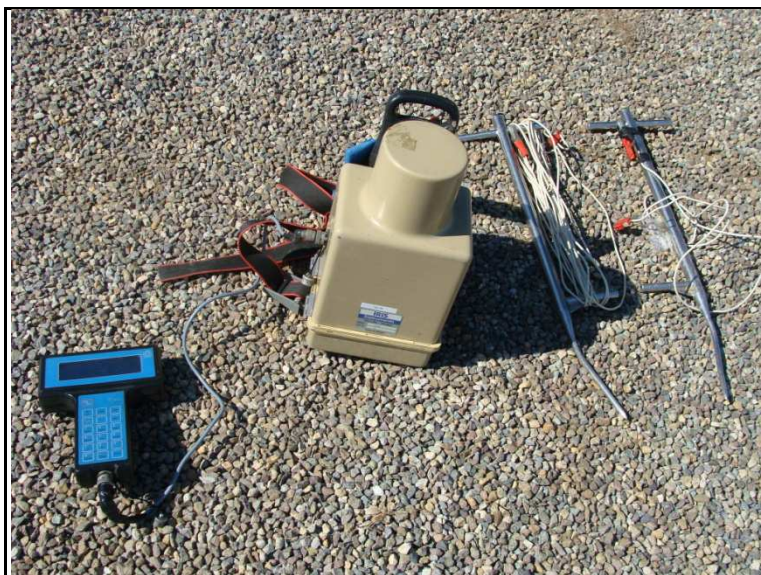
Figure - 7 : Chaîne de mesurage du T-VLF
