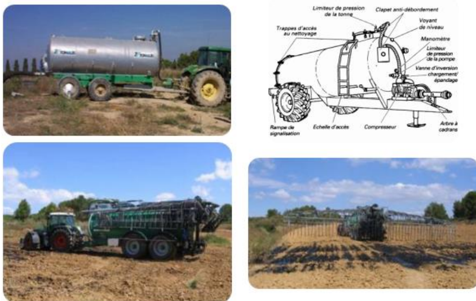
Figure 12 : Epandage en tonne à lisier - AE
