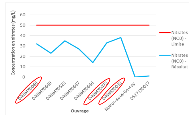
Figure 11 : Concentrations de nitrates dans les ouvrages captant la nappe profonde durant les basses eaux
