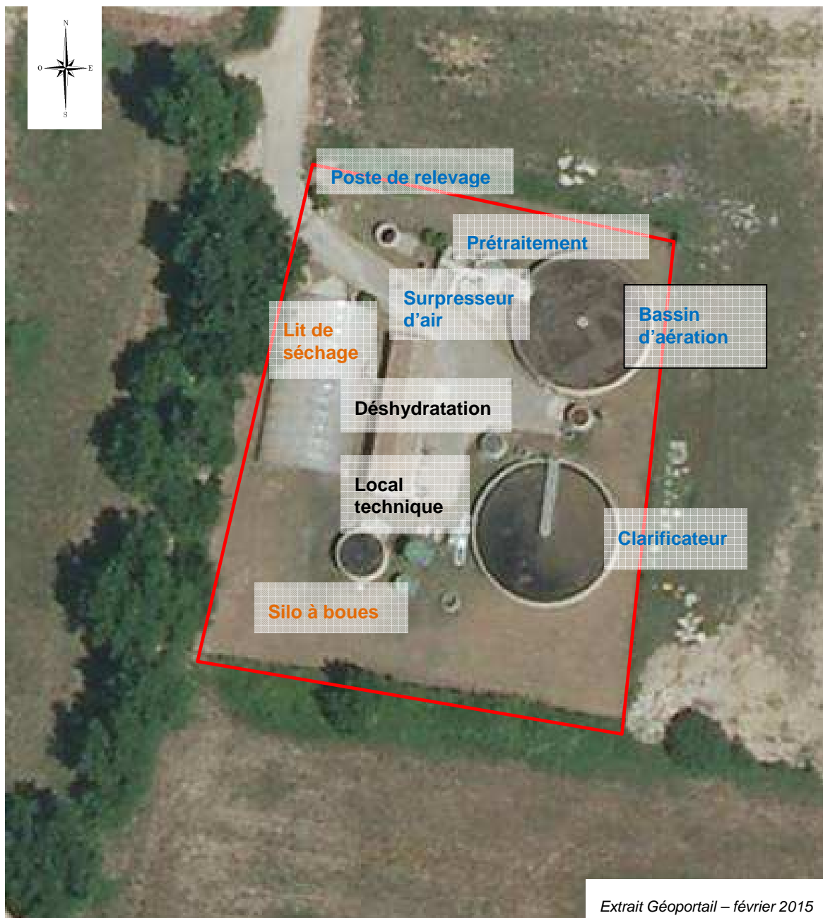
Figure 18 : synoptique de la station d'épuration
