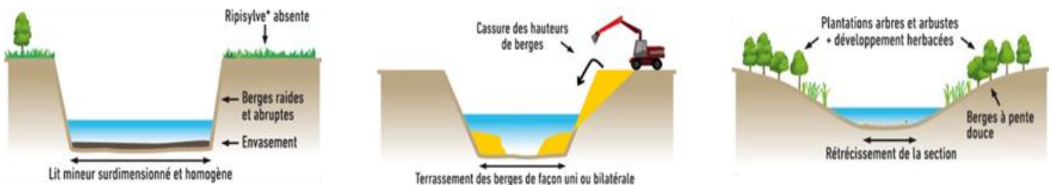
Fig. 64. Schéma de principe du déblai/remblais
