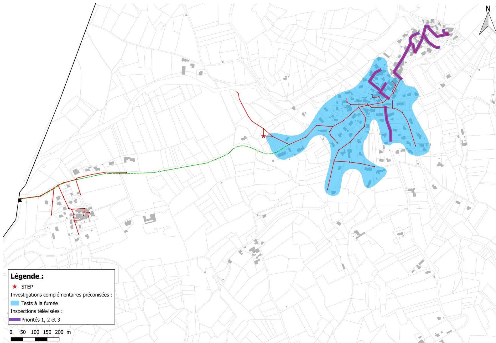
Figure 24 : Localisation des investigations complémentaires préconisées
