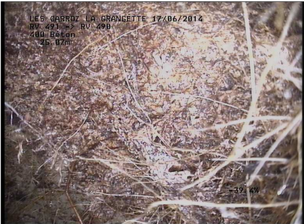
Photo: 10_16B, MPEG #: 160614_1, 00:06:56 25,07m, Racines et radicelles de 02 à 05 h.
