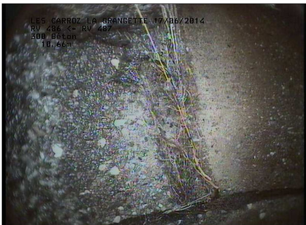
Photo: 15_6B, MPEG #: 160614_1, 00:00:36 10,66m, Racines et radicelles à 03 et 09 h.
