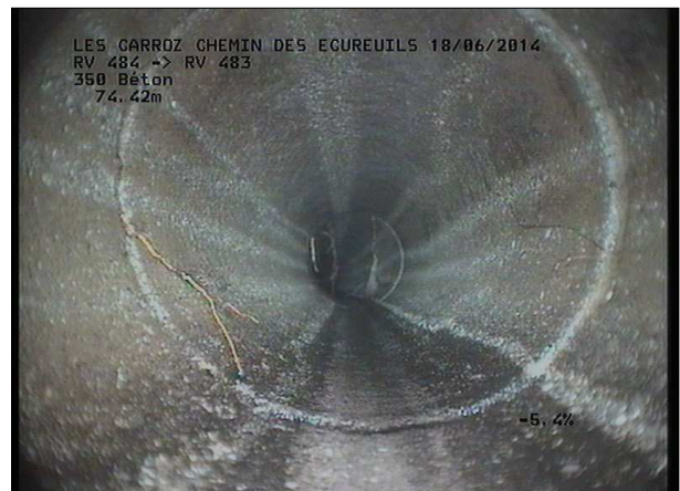
Photo: 23_17A, MPEG #: 160614_1, 00:11:53 74,64m, Radicelles à 09 h.
