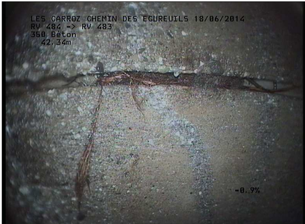
Photo: 23_9B, MPEG #: 160614_1, 00:06:08 42,34m, Radicelles à 09 h.
