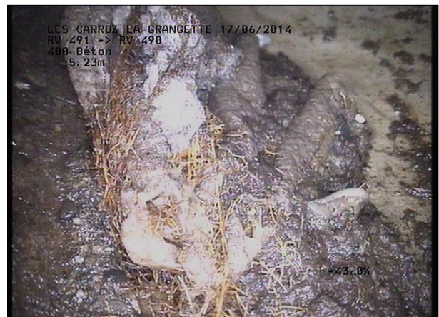
Photo: 10_5B, MPEG #: 160614_1, 00:01:46 5,23m, Dépôt de concrétions de 02 à 07 h plus racines
