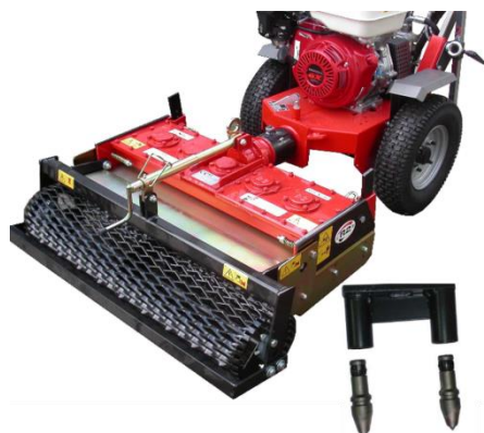
Désherbeur mécanique sur porte-outil Kersten (MTL75D), largeur : 75 cm, pointes de carbure de tungstène
