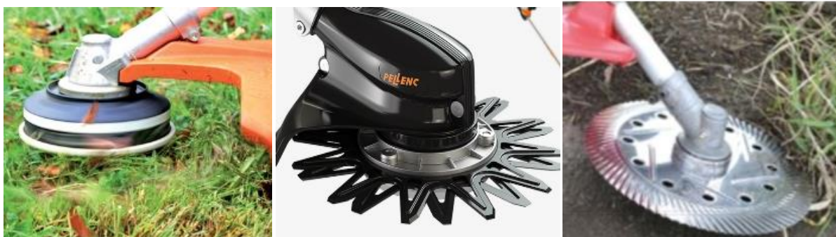
Figure 54 : Illustration d'une débroussailleuse à fil (à gauche), d'un réciprocatteur (au centre), du disque en acier souple (à droite)
