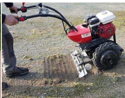
Désherbeur mécanique sur porte-outil Yvmo (MD60), largeur 0,6 à 0,70
