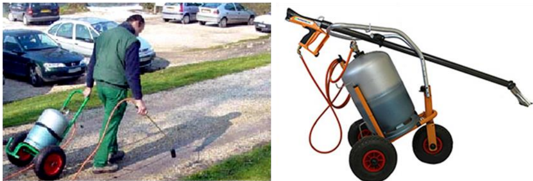
Figure 35 : Exemple de désherbeurs thermiques à flamme directe (portés sur chariot, à dos, à rampe) Coût d'acquisition : 350 à 8 000 €
