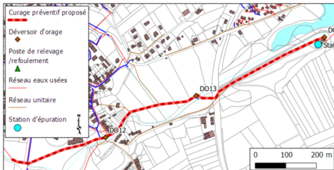
Figure 12 : Curage préventif tronçon le long du Furon, 1150 m
