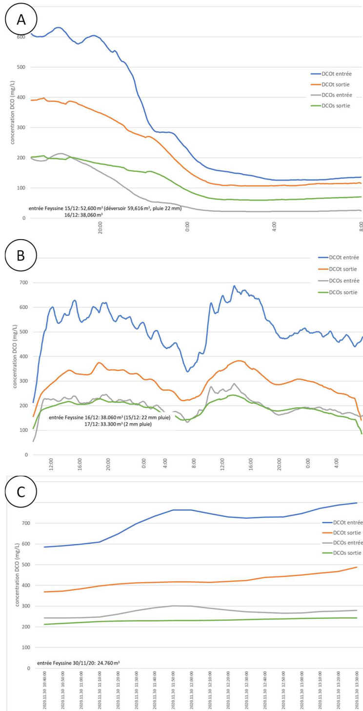
Figure 11. Suivi de la performance d'enlèvement de la DCOt et de la DCOf au cours de 3 essais sur le dispositif pilote : A Coagulant \text{FeCl}_3 26,4 mg/L, 15/12-16/12/2020, B Coagulant \text{FeCl}_3 26,4 mg/L, flocculant Polyacrylamide anionique AN923 1 mg/L, 16/12-18/12/2020 C Coagulant \text{FeCl}_3 26,4 mg/L, flocculant Tanin FL5323 1 mg/L, 30/11/2020
