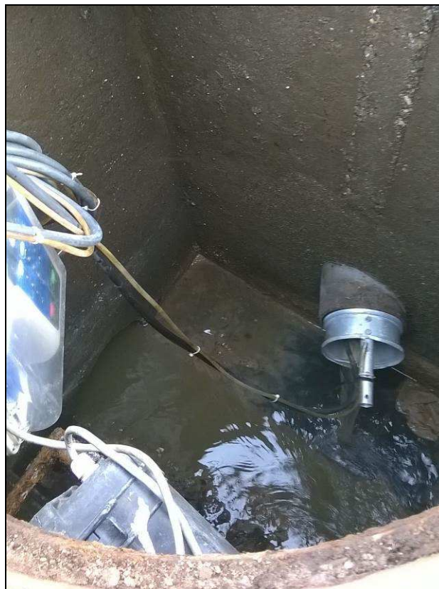
Débitmètre type SIGMA 950 « bulle à bulle » avec manchon déversoir
