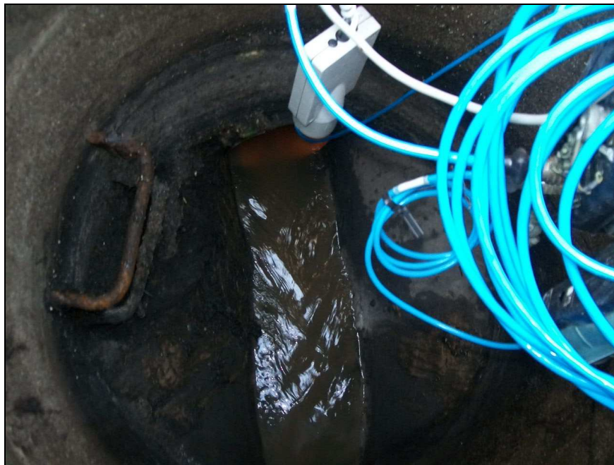
Débitmètre de type Mainstream avec sonde doppler
