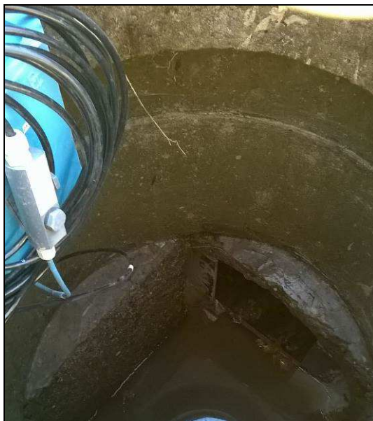
Enregistreur de type Octopus C avec sonde de pression
