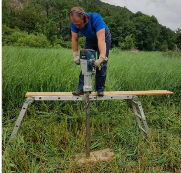
Illustration 4 : Fonçage des pointes perdues
