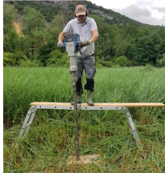
Illustration 4 : Fonçage des pointes perdues
