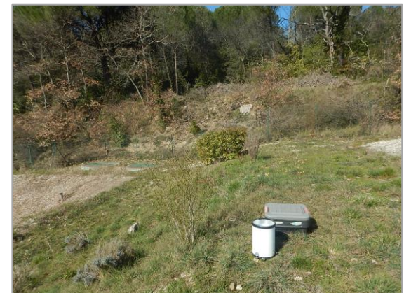
Pluviomètre à la STEP
