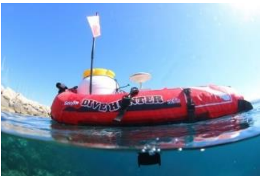
Figure 7 : Le Seaviews Tw est une bouée de chasse modifiée pour embarquer du matériel de mesure. Elle embarque notamment une antenne GPS sur sa partie émergée. Un système de fixation sur sa partie immergée permet de monter un ou plusieurs appareils (société Seaviews)
